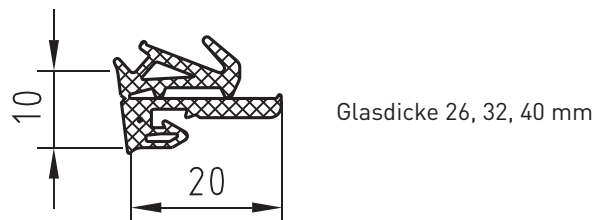
760 426 Verglasungsdichtung innen EPDM senkrecht für Polygonfassade, VE 50 m Glasdicke 26, 32, 40 mm
